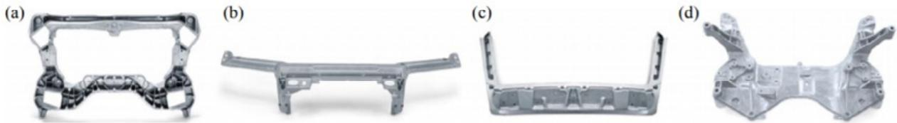
(a)汽車引擎支架；(b)汽車的前框架；(c)汽車尾門框架；(d)汽車底盤構件<sup>(8)</sup>
